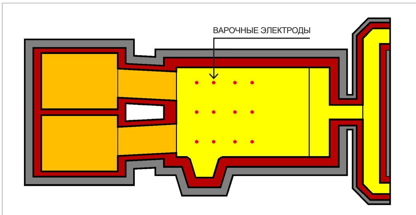
При установке для увеличения съёма печи, электроподогрев как правило может обеспечить дополнительно 30% стекла, сваренного свыше расплава за счёт природных источников тепла. Примите во внимание, что электроподогрев рекомендуется для печей с цветным стеклом (зелёным, коричневым и т.д.) для поддержания донных температур.
